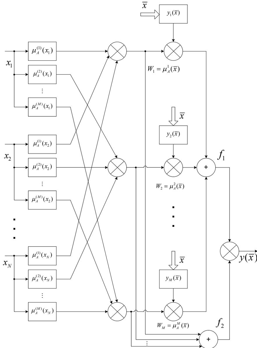
Рисунок 2 – Структура ННС типа TSK для аппроксимации функций многих переменных
