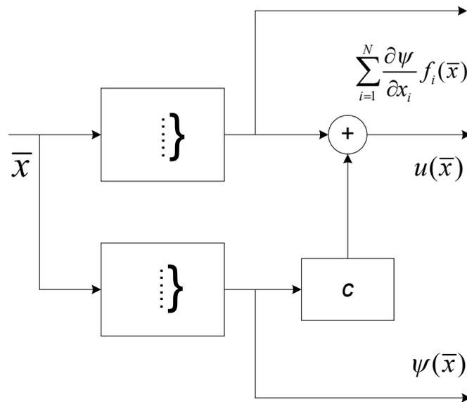
Рисунок 3 – Структура гибридного регулятора на двух ННС типа TSK
